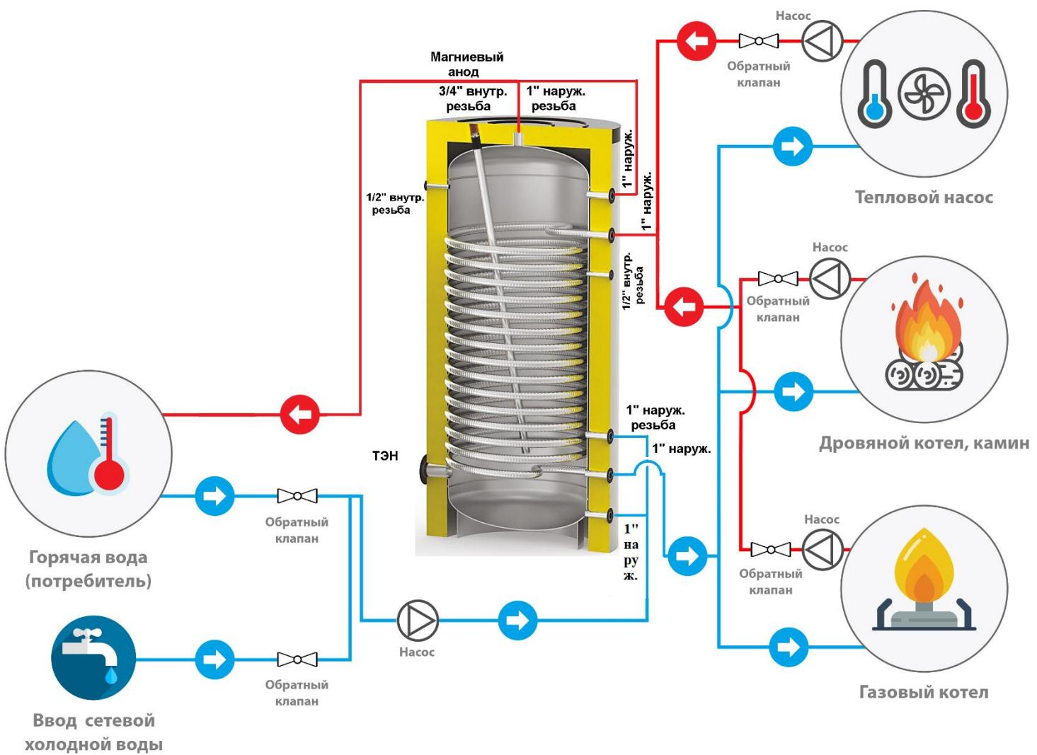
Область применения – накопление и аккумулирование нагретой санитарной воды от Теплового насоса либо котлов высокой мощности.
