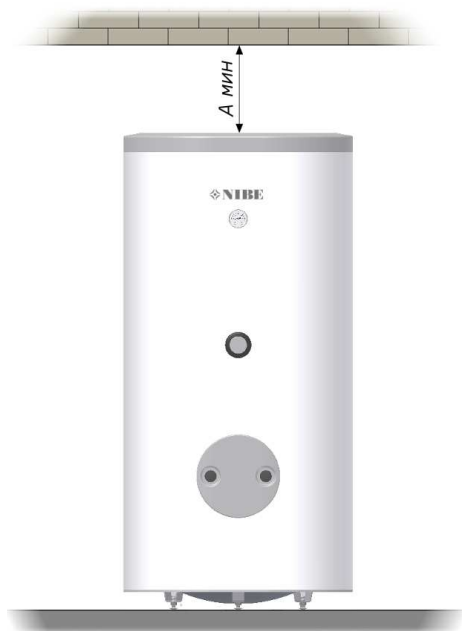
Рис. 3 Минимальное расстояние для замены защитного магниевого анода.
