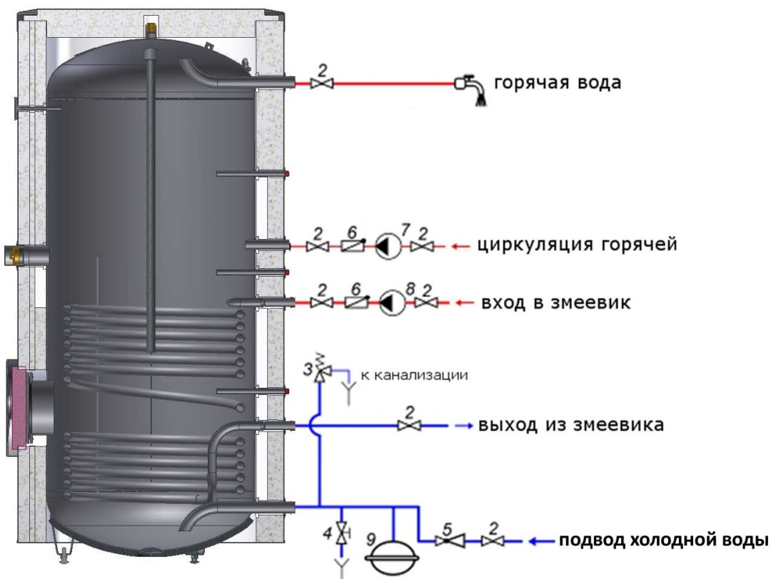
Рис. 6 Схема установки W-E 750/1000.81 R
