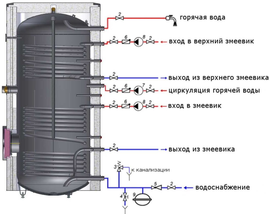
Рис. 7 Схема установки W-E 750/1000.82 R
