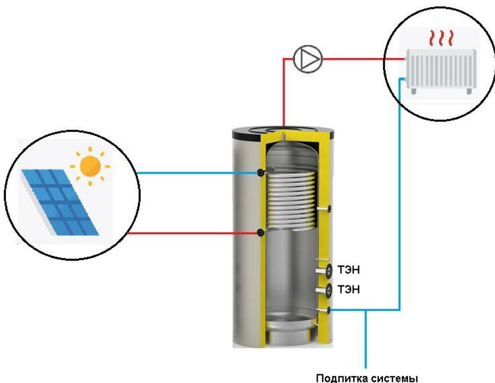
Область применения: - Накопление и аккумулирование нагревого теплоносителя закрытой отопительной системы.
