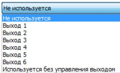
*Внимание! Если в качестве терморегулятора зоны используется трёхходовой кран, то для управления им используется два выхода. Для вращения в сторону открытия тепла используется выход, указанный в настройках. Для вращения в сторону перекрытия тепла используется выход с номером, указанным в настройках. ПЛЮС для этих выходов должен быть ОДИН.*
