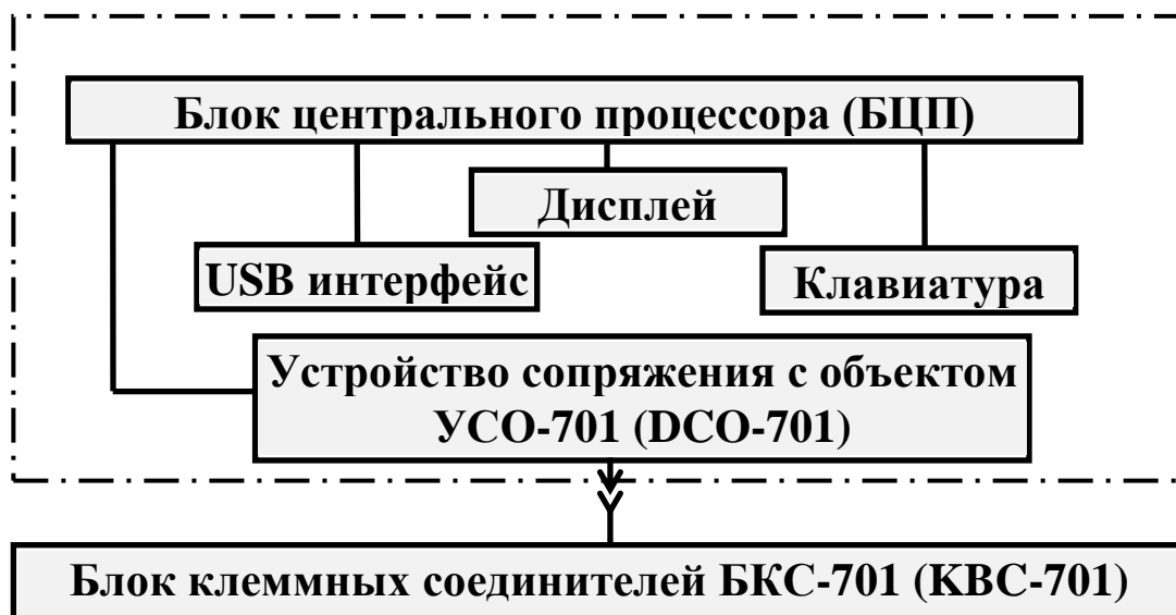
Рисунок 2 - Структурная схема контроллера
