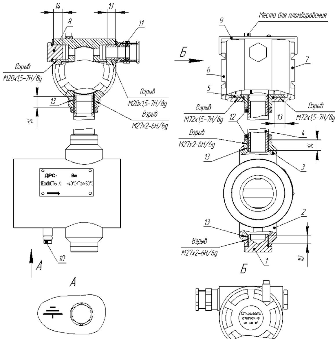
1-Гайка; 2-Бобышка; 3-Бобышка; 4-Стойка; (Корпус 010А фирмы ЗАО "Глобальная инженеринговая компания" в составе: 5-Корпус, 6, 7-Крышки; 8-Штуцер); 9-Скоба, 10-Винт с шестигранной головкой ГОСТ Р ИСО 4017-М6x12-5.6-А9А, 11-Кабельный ввод ATELEX 20НК № IP67 фирмы АТЭК-Электра; 12-Контргайки; 13-Компаунд Permatex Pipe joint Compound 51d.
