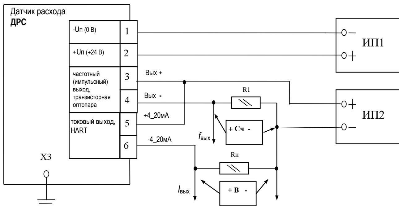
ИП1, ИП2 – источник питания постоянного тока с напряжением  $U_{п}=(24\pm 4)\text{В}$ ;
