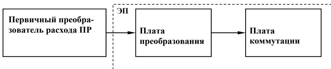
Рисунок 1 - Структурная схема датчика расхода без цифрового выхода.
