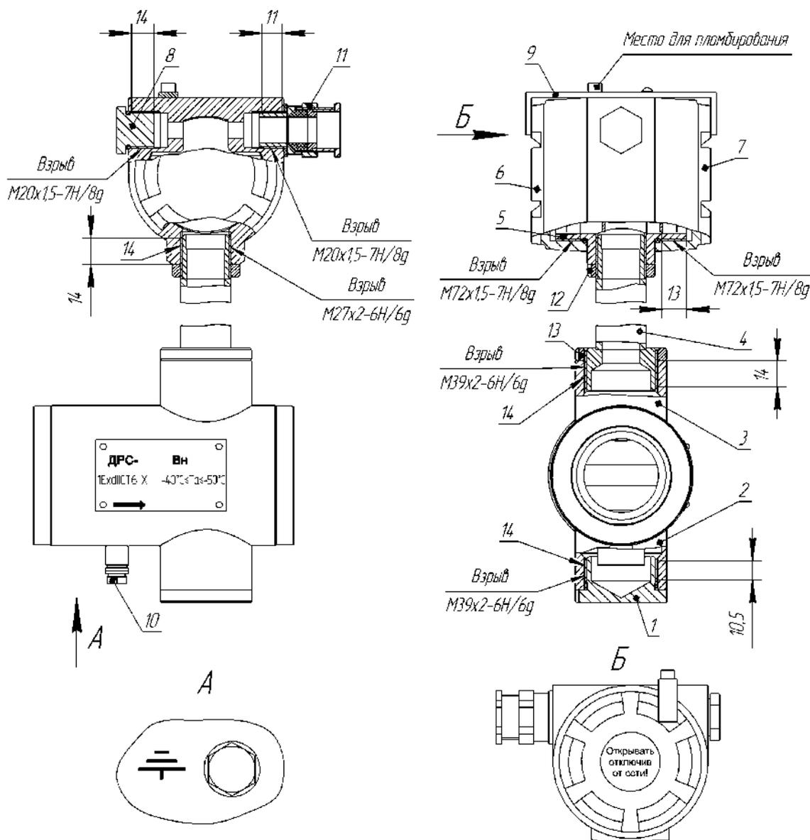
1-Гайка; 2-Бобышка; 3-Бобышка; 4-Стойка; (Корпус 010А фирмы ЗАО "Глобальная инженеринговая компания" в составе: 5-Корпус; 6, 7-Крышки; 8-Штуцер); 9-Скоба; 10-Винт с шестигранной головкой ГОСТ Р ИСО 4017-М6x12-5.6-А9А; 11-Кабельный ввод ATELEX 20НК Ni IP67 фирмы АТЭК-Электро; 12-Контргайка; 13-Гайка; 14-Компаунд Permatex Pipe joint Compound 51d.
