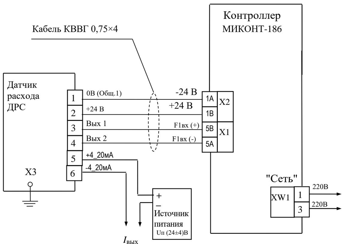
Рисунок В.4 – Схема электрическая соединений и подключения датчика расхода ДРС с контроллером МИКОНТ-186
