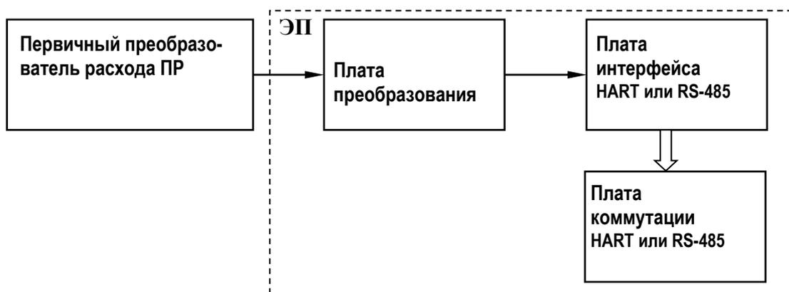
Рисунок 2 - Структурная схема датчика расхода с цифровым выходом.
