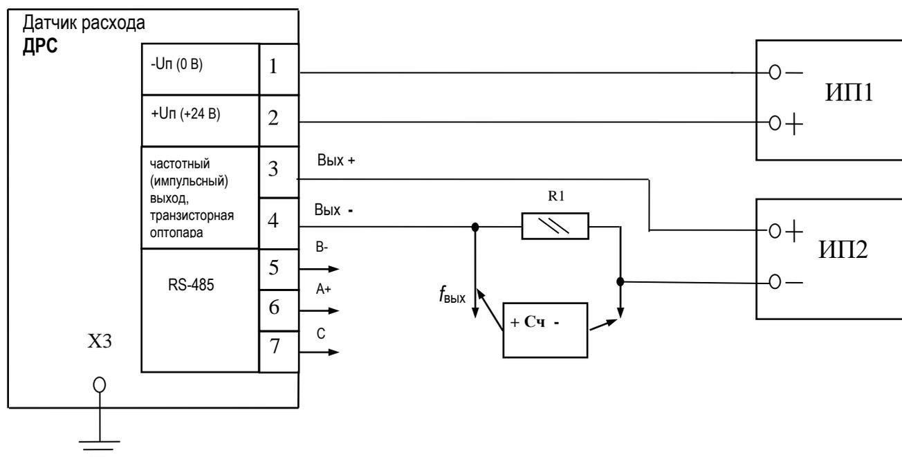
ИП1, ИП2 – источник питания постоянного тока с напряжением  $U_{\text{п}}=(24\pm 4)\text{В}$ ;
