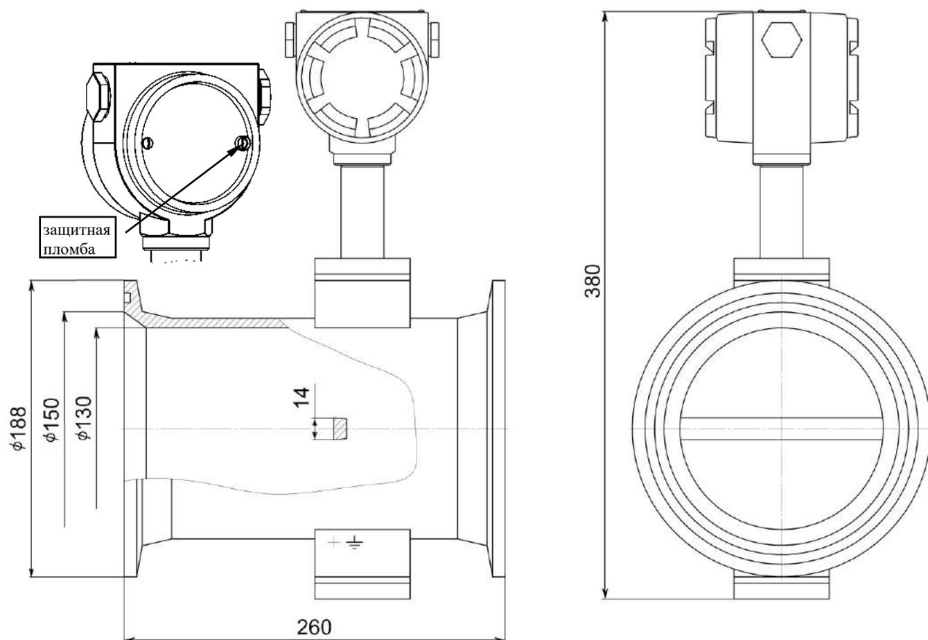
Рисунок А.7 – Датчик расхода ДРС-500Н. Общий вид
