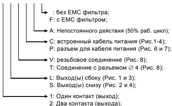
Например: TC2LVPAF - это трансформатор серии TC непостоянного действия имеет 2 боковых выхода, резьбовое соединение высоковольтного кабеля, без встроенного кабеля питания (поставляется отдельно), со встроенным EMC фильтром.
