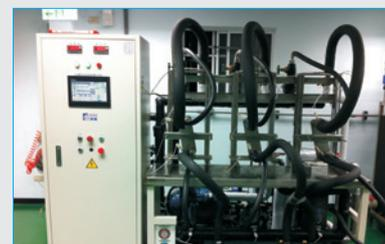
Испытательный стенд по тепловым ударам
